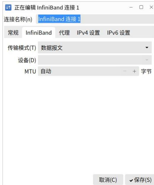
图 2.88 选择无线宽带的传输模式和设备
